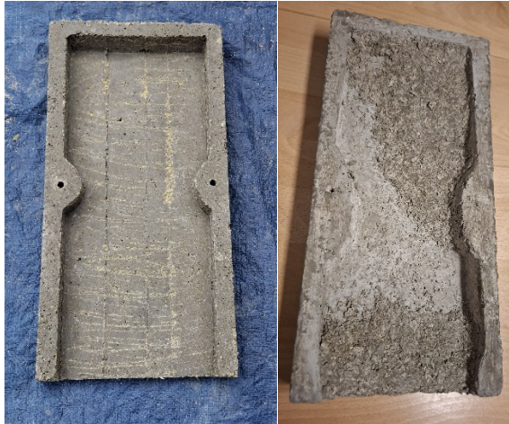
Abbildung links: ausgeschalte Wandschale, rechts: Wandschale mit nachträglich eingefülltem Holzbeton
