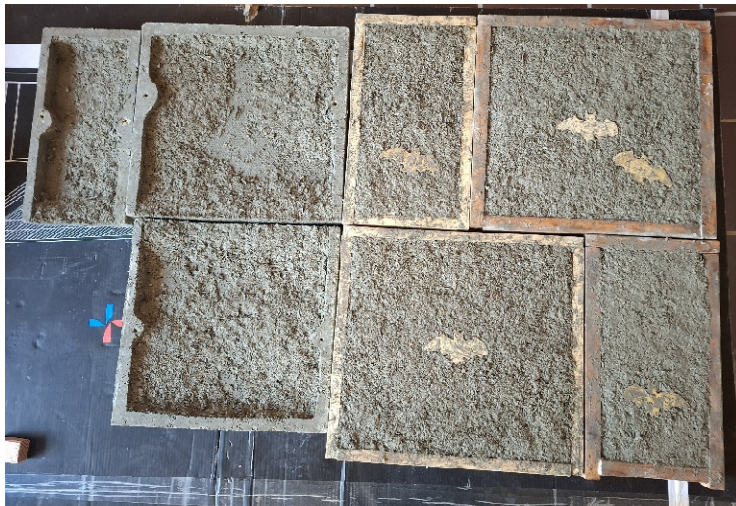
Abbildung linke Seite: ausgeschalte Wandschalen mit nachträglich eingefügtem Holzbeton, rechte Seite: Formen gefüllt mit Holzbeton und Holzfledermäusen
