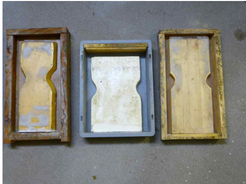
Abbildung: links Form mit Innenteil, mitte Eurobox als Form mit Holzstück für eine Dachschräge und Innenteil, rechts: Holzform mit Innenteil aus Holz, welche mit genoppter Folie bedeckt wurde.
