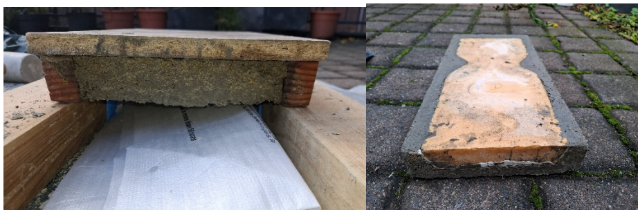
Abbildung links: Ausschalen aus einer Holzform durch Klopfen des Rahmens auf Holzbalken; rechts: nach dem Ausschalen ist die Hartschaumform sichtbar und kann entfernt werden.
